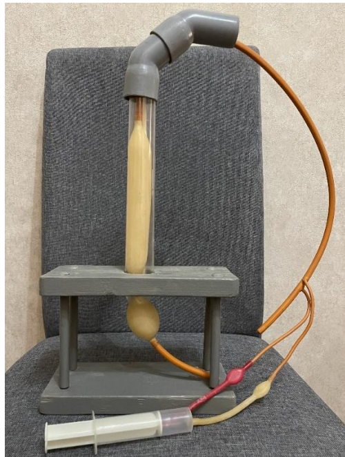
Рисунок 22 – Стенд, имитирующий верхние отделы пищеварительного тракта
