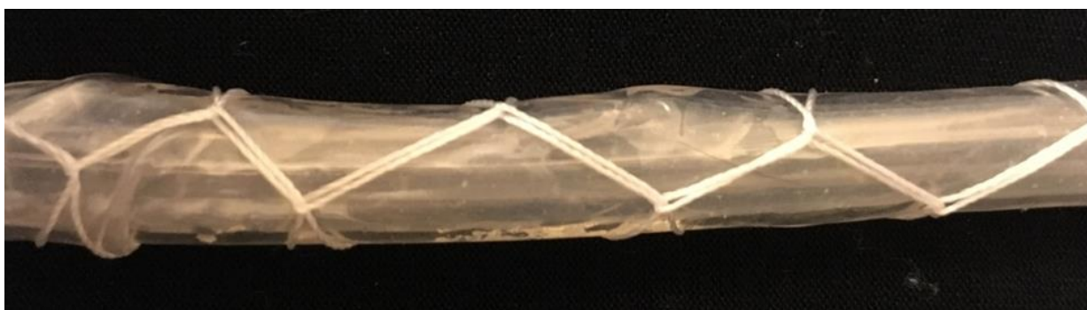
Рисунок 19 – Схема плетения фиксирующей нити
