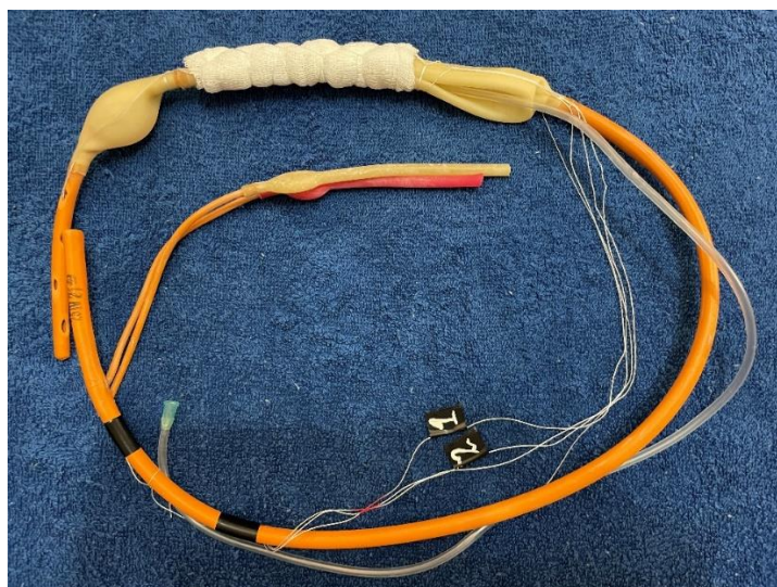
Рисунок 26 – Внешний вид готового к применению зонда для химико-механического гемостаза
